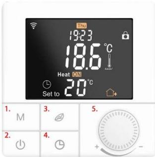
1. Mode-Taste, kurzer Tastendruck wechselt den Betriebsmodus, langer Tastendruck (5 Sek.) Programmierung Wochenprogramm
