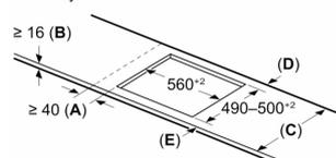
**A:** Min. razdalja med izrezom za kuhavno ploščo in steno
